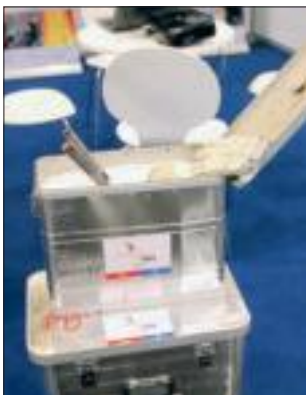
Abgelöscht: Die Transportbehälter mit der PyroBubbles-Füllung lassen sich auch zum Löschen von brennenden Bengalos nutzen.
