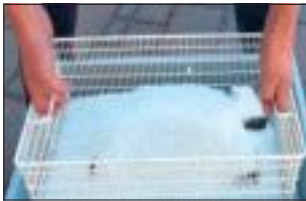
Dicht: Der Akku wird beim Transport komplett von den PyroBubbles umschlossen.
