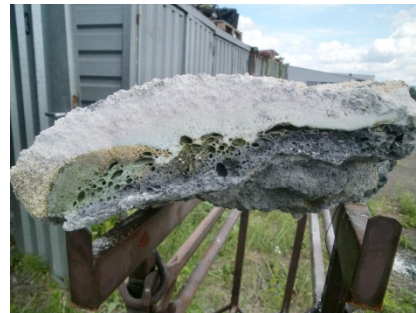
Bild D: geschmolzene Glasschicht
