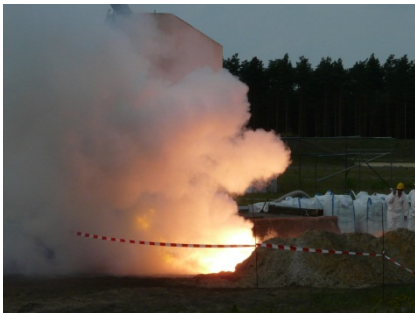
Bild C: 245 kg brennendes Magnesium (BAM, Sperenberg)
