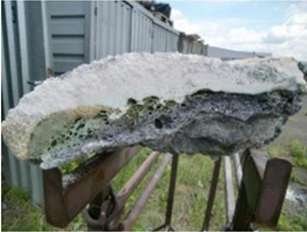
Abbildung C: Glaskokon um das gelöschte 245 kg Magnesiumbinde
