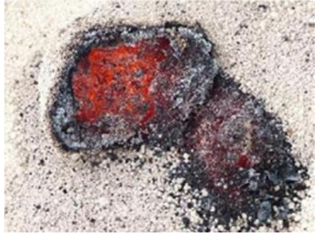
Abbildung D: PyroBubbles umschließen den Brandherd sicher.
