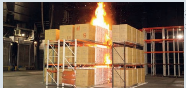
Brandversuch von FM Global: Brennen erst einmal größere (Mengen) Lithium-Ionen-Batterien, ist das Feuer nicht mehr löschar.
